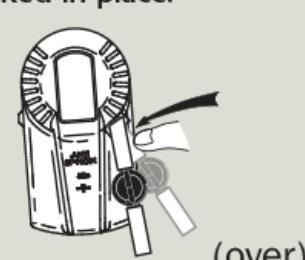
**1** a) Fermez l'alimentation en eau. Placez seau. Actionnez chasse d'eau. Enlez l'eau restante à l'aide d'une éponge. b) Coupez l'alimentation en eau. Retirez l'écrou de montage. Utilisez une clé, au besoin. Conseil: l'eau sera dans ligne d'alimentation. c) Retirez vieille soupape.
